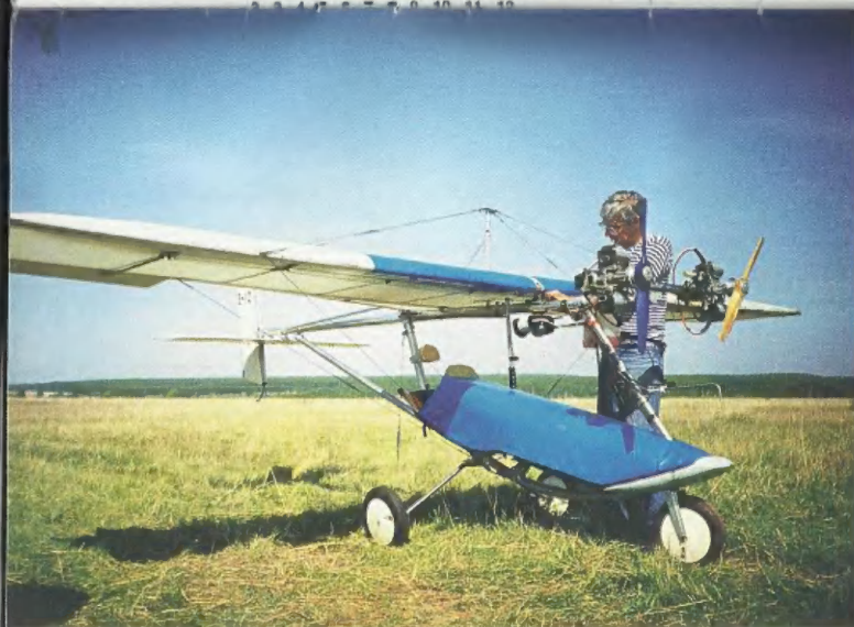
Е-12 «Стручок» - мини-самолет из г. Ульяновска. Новая разработка СТК «Взлет» с убирающимся шасси (г. Нижний Новгород).
